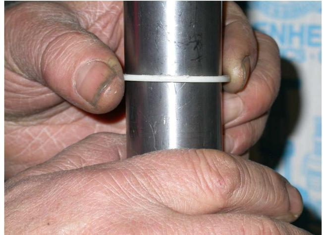
Fig.16 Togliere la seconda guarnizione
