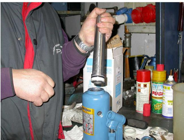
Fig.19 Estrarre il pistone 2 stadi parte posteriore del pistone più grande esercitando una notevole pressione sulla testa. Dopo la sostituzione delle guarnizioni seguire esattamente il processo inverso filtrando l'olio da rimettere nel serbatoio.
